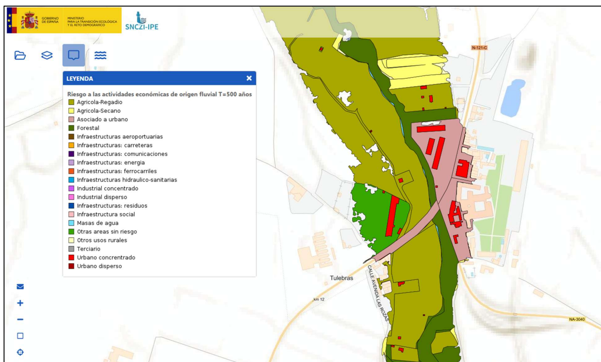
Ilustración 18. Carreteras que se verían afectadas por la inundación esperable con un período de retorno de 500 años, tal y como se muestran en los mapas elaborados para el segundo ciclo de la aplicación de la directiva de inundaciones.
